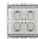
03925 2,4 GHz radyo frekans vericisine sahip dört düğmeli düz kumanda, Bluetooth Low Energy standardı, tümleşik elektrodinamik jeneratör tarafından sağlanan enerji hasatlama özellikli güç kaynağı, 2 modül.
