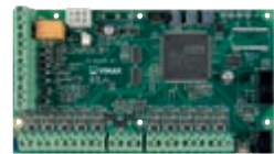
▲03800 Unitate de comandă By-alarm Plus extensibilă la 25 zone
