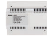
938A salida 15 V, alimentación 230 V~ 50/60 Hz 55 VA, función de llamada en placa, con triple generador de nota
