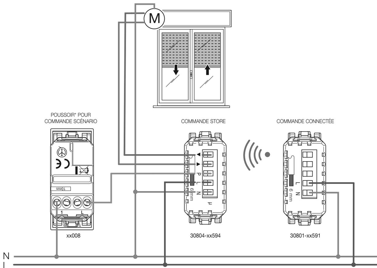
\* Ne pas utiliser l'unité de signalisation 00931. Le poussoir peut être utilisé uniquement en cas de fonctionnement en mode Bluetooth technology.
