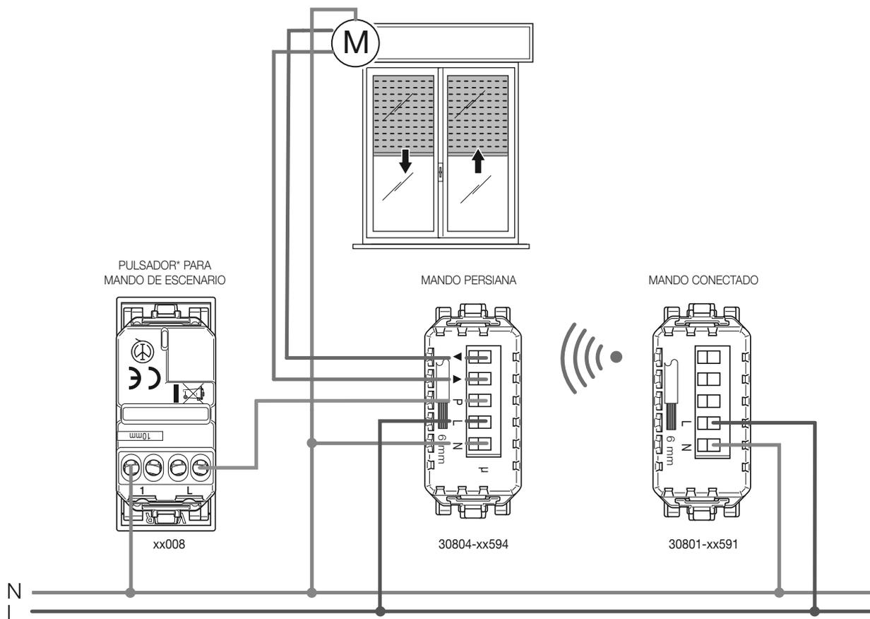
\* No utilice la unidad de señalización 00931. El pulsador se puede utilizar solo en caso de funcionamiento con Bluetooth technology.
