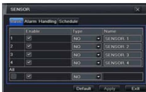
Passaggio 3: Abilitare l'allarme sensore (specificare il canale), selezionare il tipo di sensore e fare clic su 'Applica' per salvare le impostazioni.
