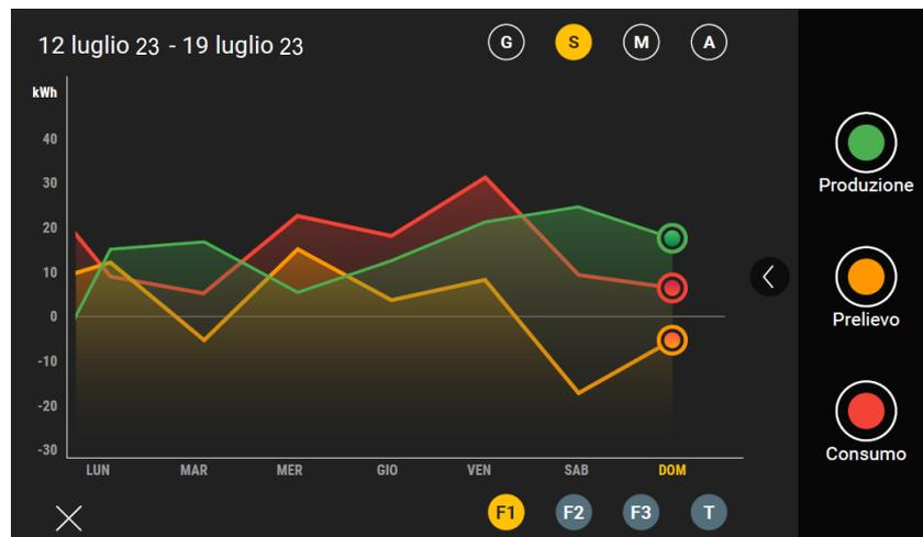
Con F1, F2 e F3 si visualizzano i dati di ogni singola fase mentre con T l'unione di tutte e tre le fasi.
