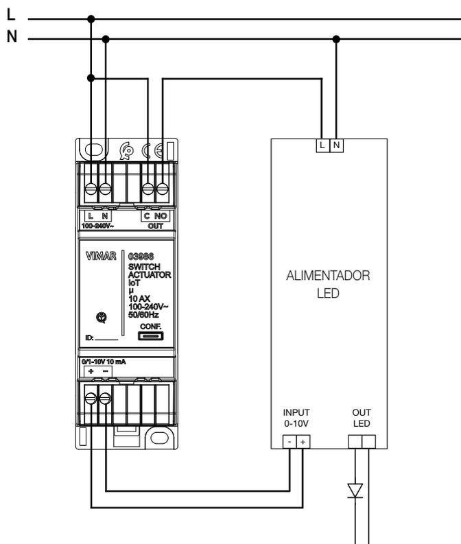
Distancia máxima entre actuador y alimentador LED: 50 m. Utilice un cable trenzado con sección mínima de 0,5 mm<sup>2</sup> (art. 01840.E).
