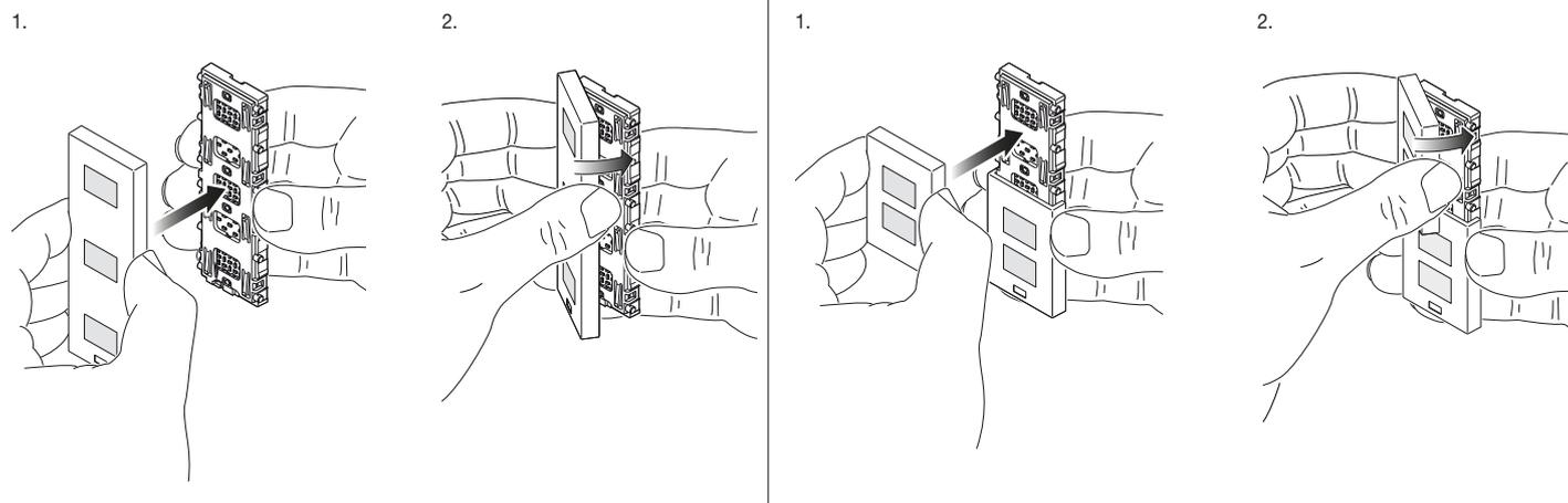
ABNAHME DER TASTE - Den Schraubendreher an den angegebenen Stellen einsetzen.
