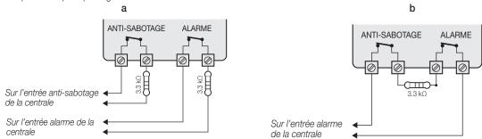
Le cas a utilise 2 bornes distinctes pour les signaux d'alarme et d'anti-sabotage.
