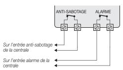
Pour détecter le sabotage/anti-sabotage, connecter le signal correspondant à une borne configurée comme ZONE GÉNÉRIQUE type MAINTENANCE.
