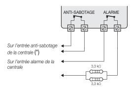
(\*) Généralement, les détecteurs stores/à inertie ne disposent pas d'une borne dédiée au sabotage/anti-sabotage.
