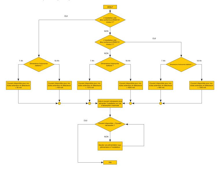
ATTENTION : Pour dimensionner correctement l'installation, toujours considérer la consommation maximale ; cette condition varie en fonction du nombre de dispositifs présents sur l'installation et de la configuration réalisée.
