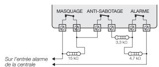
Le tableau ci-dessous fournit les valeurs (exprimées en  $\Omega$ ) de la résistance équivalente lue sur les bornes, en fonction de l'équilibrage et du signal détecté. Le tableau s'applique aux résistances de EOL fournies par défaut, à savoir  $3300\Omega$ ,  $4700\Omega$  et  $15000\Omega$ .
