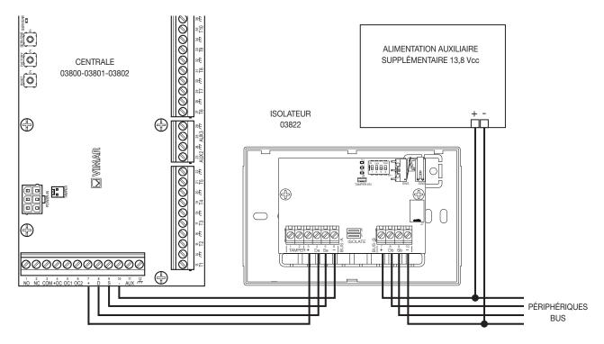
Ce cas prévoit encore l'utilisation de l'isolateur art. 03822, mais <u>les deux cavaliers doivent être coupés.</u> La centrale assure l'isolation galvanique de l'alimentation des périphériques BUS qui dispose d'une alimentation auxiliaire. Le courant maximum disponible dépend exclusivement des caractéristiques de l'alimentation auxiliaire.
