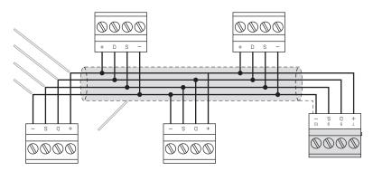
Procéder au dimensionnement de la ligne BUS, à savoir de la distribution des périphériques et de l'utilisation des câbles pour les connecter, en fonction de plusieurs facteurs de projet, afin de garantir la transmission correcte des signaux des conducteurs « D » et « S » et de l'alimentation fournie par les conducteurs « + » et « - ».
