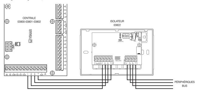
Il suffit d'utiliser l'isolateur art. 03822 avec les deux cavaliers connectés (par défaut). Dans ce cas, le BUS vers les périphériques de champ est régénéré et les conducteurs d'alimentation + et – sont les mêmes que ceux de la centrale. Les signaux du BUS sont, quant à eux, régénérés, isolés et protégés. Installer l'isolateur dans un boîtier qui devra lui aussi être protégé.
