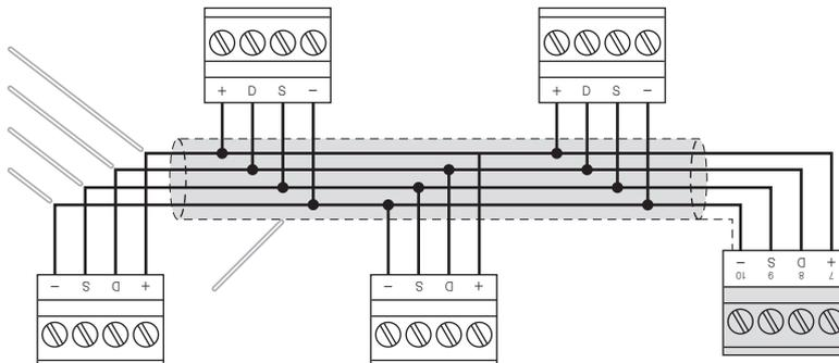
Die Dimensionierung der BUS-Leitung, also die Verteilung der Peripheriegeräte und die Verwendung der Anschlusskabel, muss gemäß verschiedenen Projektfaktoren erfolgen, um die korrekte Signalübertragung der Leiter "D" und "S" sowie der von den Leitern "+" und "-" bereitgestellten Versorgung zu garantieren.
