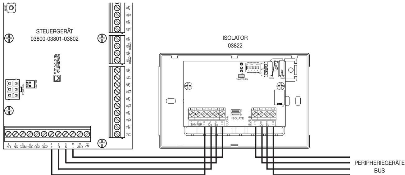
Einfach den Isolator Art. 03822 mit den zwei angeschlossenen Jumpern (Standard) verwenden. In diesem Fall wird der BUS zu den Feld-Peripheriegeräten regeneriert, wobei die Versorgungsleiter + und – mit denen des Steuergeräts identisch sind. Die BUS-Signale sind hingegen regeneriert, isoliert und geschützt. Der Isolator wird in einem geschützten Gehäuse installiert.
