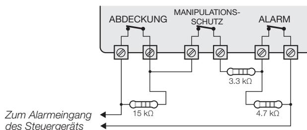
In folgende Tabelle sind die Werte (in Ω) des äquivalenten Widerstands an den Klemmen in Abhängigkeit vom Abgleich und dem erfassten Signal angegeben. Die Tabelle gilt für die werkseitig gelieferten EOL-Widerstände 3300Ω, 4700Ω und 15000Ω.
