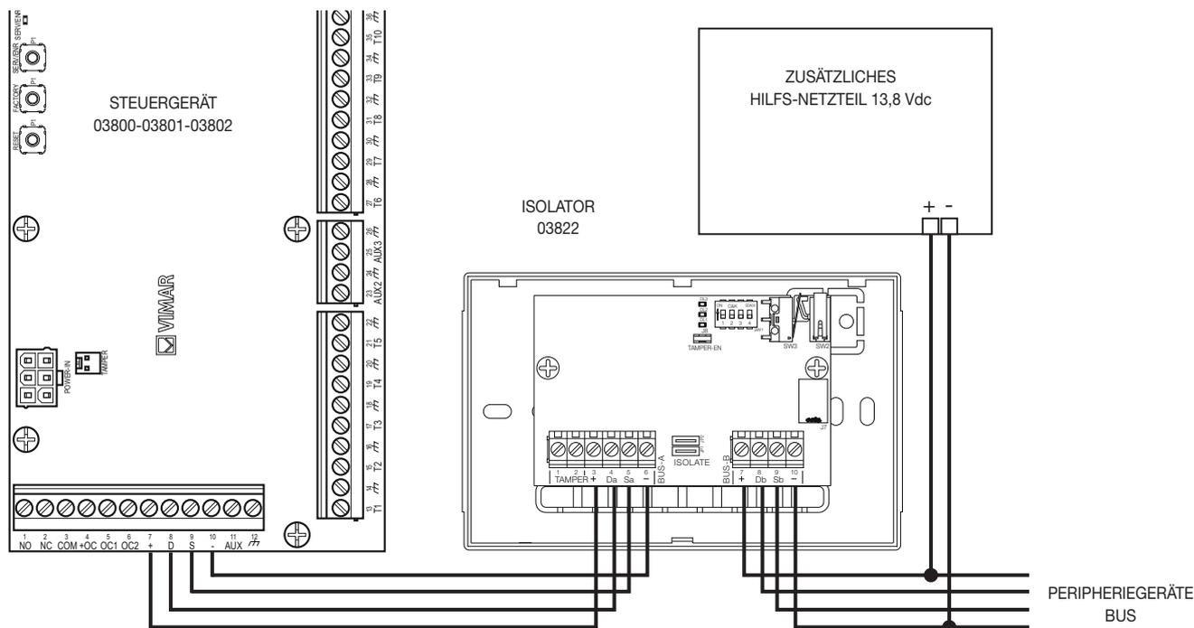
In diesem Fall wird abermals der Isolator Art. 03822 eingesetzt, aber mit beiden geschnittenen Jumpern. Die Versorgung der BUS-Peripheriegeräte ist vom Steuergerät galvanisch isoliert und wird über das Hilfs-Netzteil bereitgestellt. Der maximal verfügbare Strom hängt ausschließlich von den Merkmalen des Hilfs-Netzteils ab.
