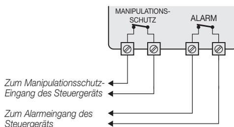
Zur Meldung von Sabotage/Manipulation muss das entsprechende Signal an eine als ALLGEMEINE ZONE vom Typ MANIPULATION konfigurierte Klemme angeschlossen werden
