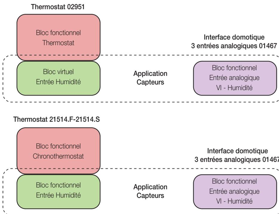
REMARQUE Cette même application capteurs peut comprendre plusieurs blocs Entrée Humidité des différents thermostats/varianteurs climatisation.
