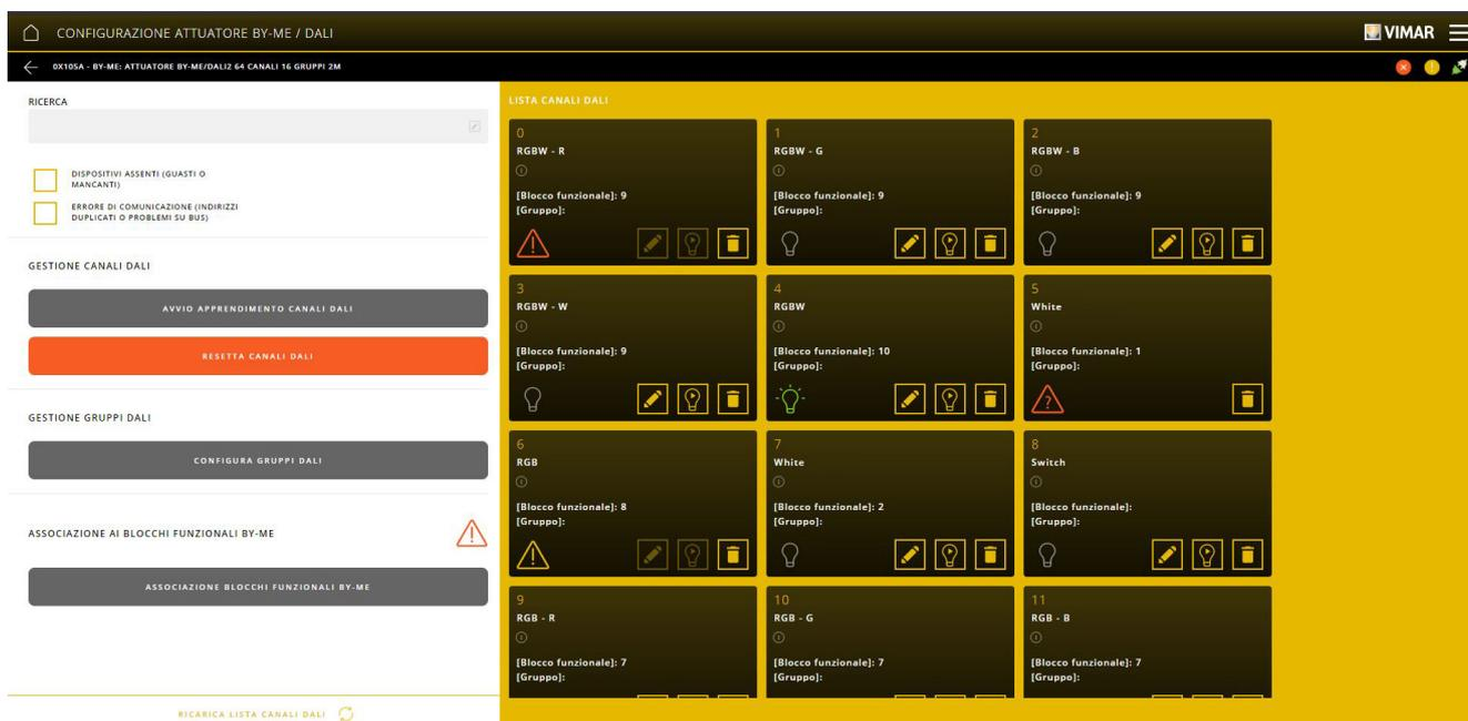
L'actuateur comprend 16 blocs fonctionnels indépendants auxquels il est possible d'associer jusqu'à 64 canaux DALI/DALI-2.
