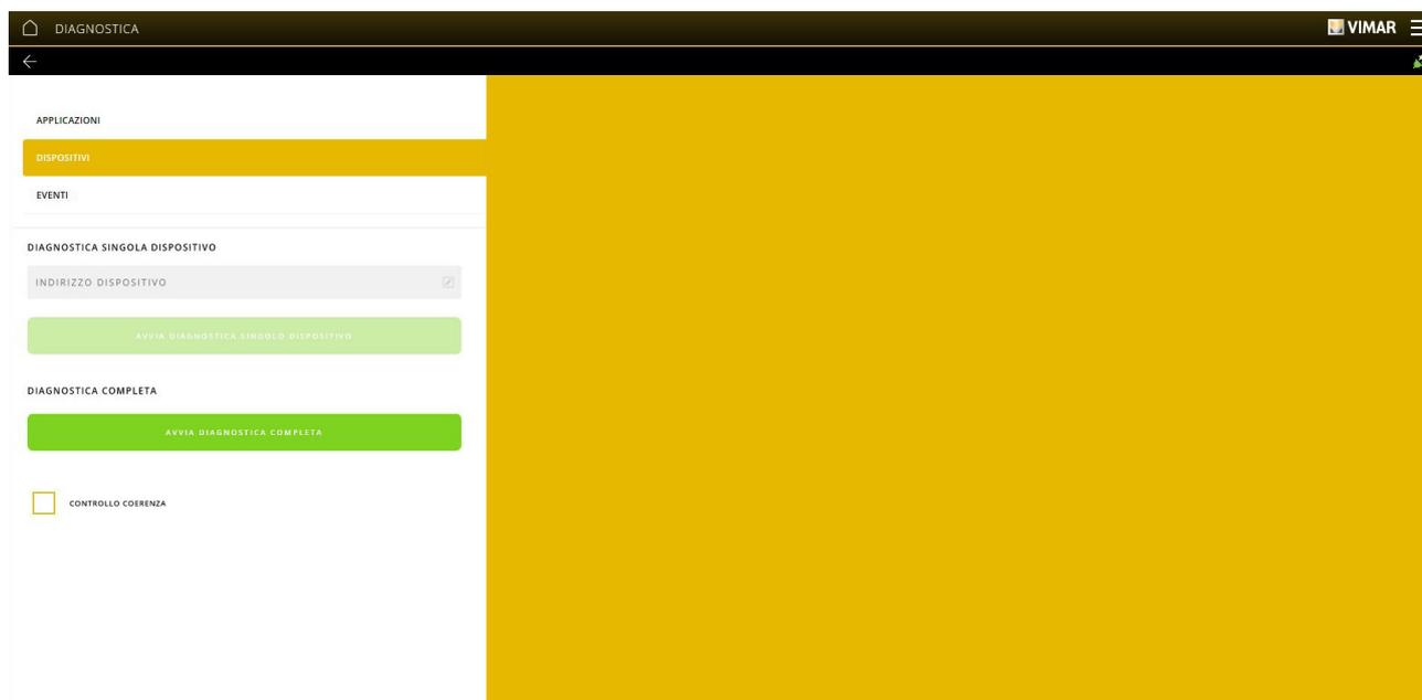
El diagnóstico se realiza solo en los dispositivos By-me (excepto dispositivos KNX, estación meteorológica, etc.) y permite comprobar si los datos presentes en los diferentes dispositivos corresponden a los configurados en las aplicaciones (comparando la configuración de los dispositivos presentes en el bus y el contenido de la base de datos). À la fin, le résultat de l'opération s'affiche avec la comparaison des données et les dispositifs impliqués.
