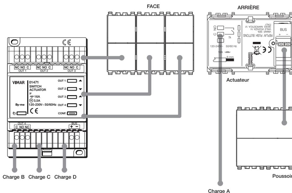
Aucune contrainte ne lie les blocs fonctionnels d'un dispositif physique. Pour commander une charge, il faut prévoir un dispositif (commande ou superviseur) et un actuateur relié à la charge.
