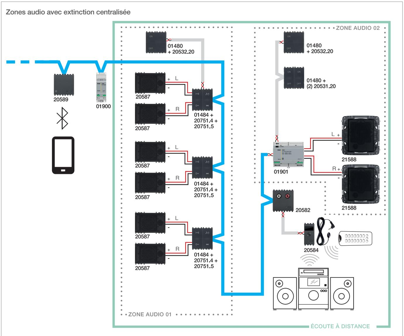
**Dispositifs configurés :** 1 entrée audio 20582, 1 syntoniseur FM 01900 et 1 interface *Bluetooth technology* 30495-20589 (modules transmetteurs), 4 amplificateurs audio 30484-01484 et 01901 (modules récepteurs) et leurs commandes 20751.4 et 20751.5, 3 commandes By-me 30480-01480 et 1 interface IR 20584.
