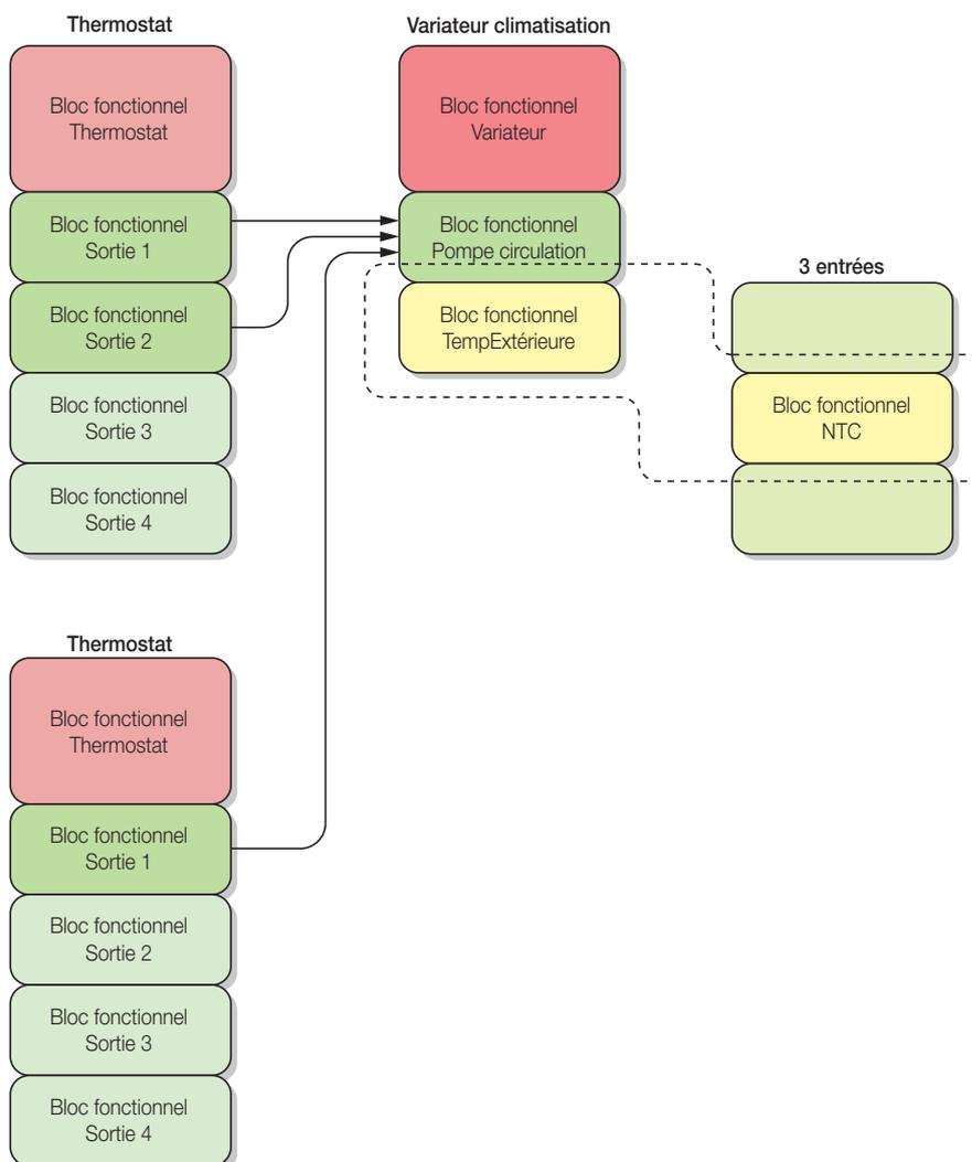
**N.B.:** quand on configure le bloc fonctionnel **Température extérieure** dans une application dédiée et que ce bloc est le premier configuré, le variateur (qui a la sonde physiquement reliée à ses bornes) donne la température extérieure aux autres variateurs 01465 ; il suffit de configurer successivement dans la même application tous les blocs de Température extérieure des autres variateurs pour qu'ils reçoivent la mesure.
