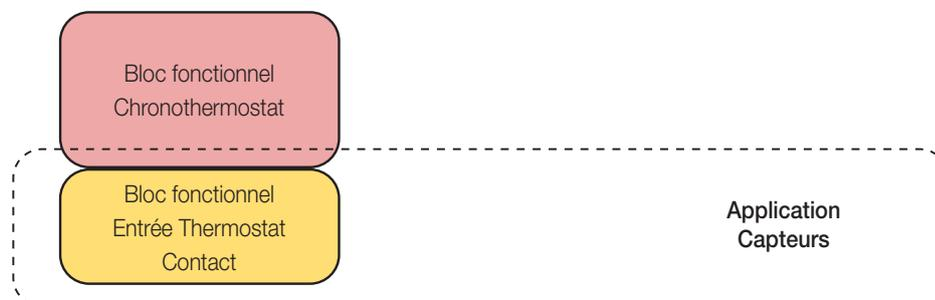
**REMARQUE** L'application Capteurs permet ensuite de configurer les blocs fonctionnels ENTRÉE CONTACT BLOC DEPUIS BUS d'autres thermostats afin de pouvoir les éteindre à partir d'un seul contact.
