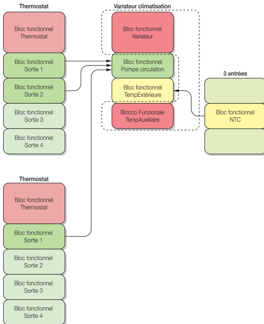
N.B. : si la configuration est effectuée dans les applications vides d'un variateur de climatisation dont le bloc fonctionnel principal est configuré mais pas les blocs fonctionnels Température extérieure et Température auxiliaire, le système demande si on souhaite configurer ces blocs ; si on décide de continuer, la configuration se poursuit automatiquement sans afficher d'autres questions.
