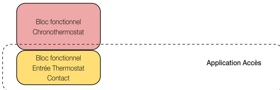
**REMARQUE** L'application Accès permet ensuite de configurer les blocs fonctionnels ENTRÉE CONTACT FENÊTRE DEPUIS BUS d'autres thermostats afin de pouvoir les éteindre à partir d'un seul contact Fenêtre.
