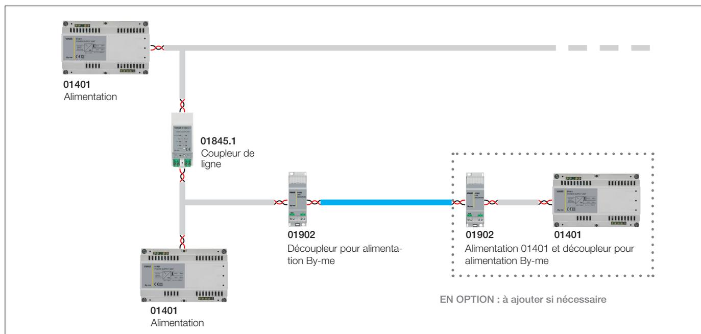
Les dispositifs de diffusion sonore sont configurés sur une ligne différente des autres dispositifs By-me. La seconde alimentation et le découpleur dédié sont des options et ne doivent être installés que pour réduire la consommation.
