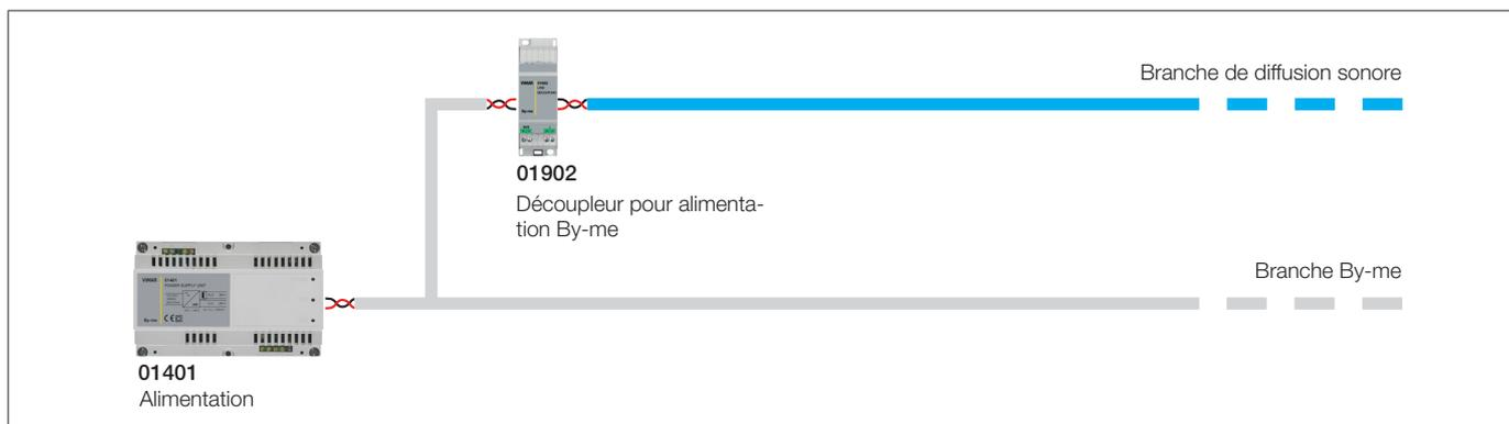
La séparation porte uniquement sur le câblage et non sur la logique : les dispositifs de diffusion sonore et les dispositifs By-me sont configurés sur la même ligne.
