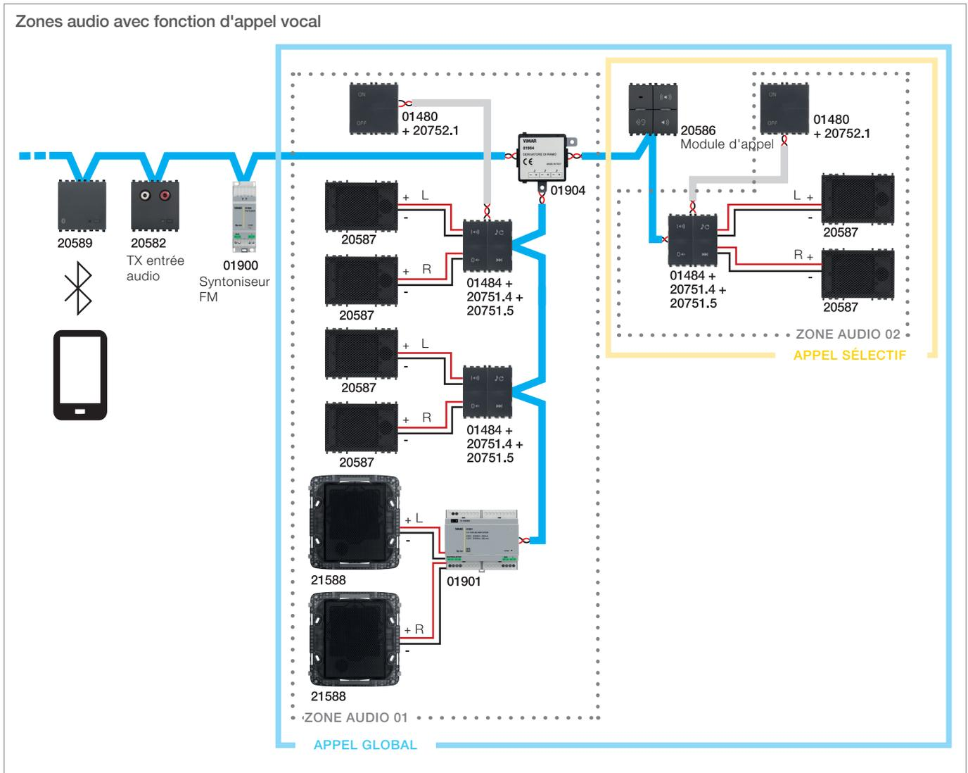
**Dispositifs configurés :** 1 entrée audio 20582, 1 syntoniseur FM 01900 et 1 interface *Bluetooth technology* 30495-20589 (modules transmetteurs), 4 amplificateurs audio 30484-01484 et 01901 (modules récepteurs) avec les touches de commande correspondantes 20751.4 et 20751.5, 2 commandes By-me 30480-01480 et 1 module d'appel 20586.
