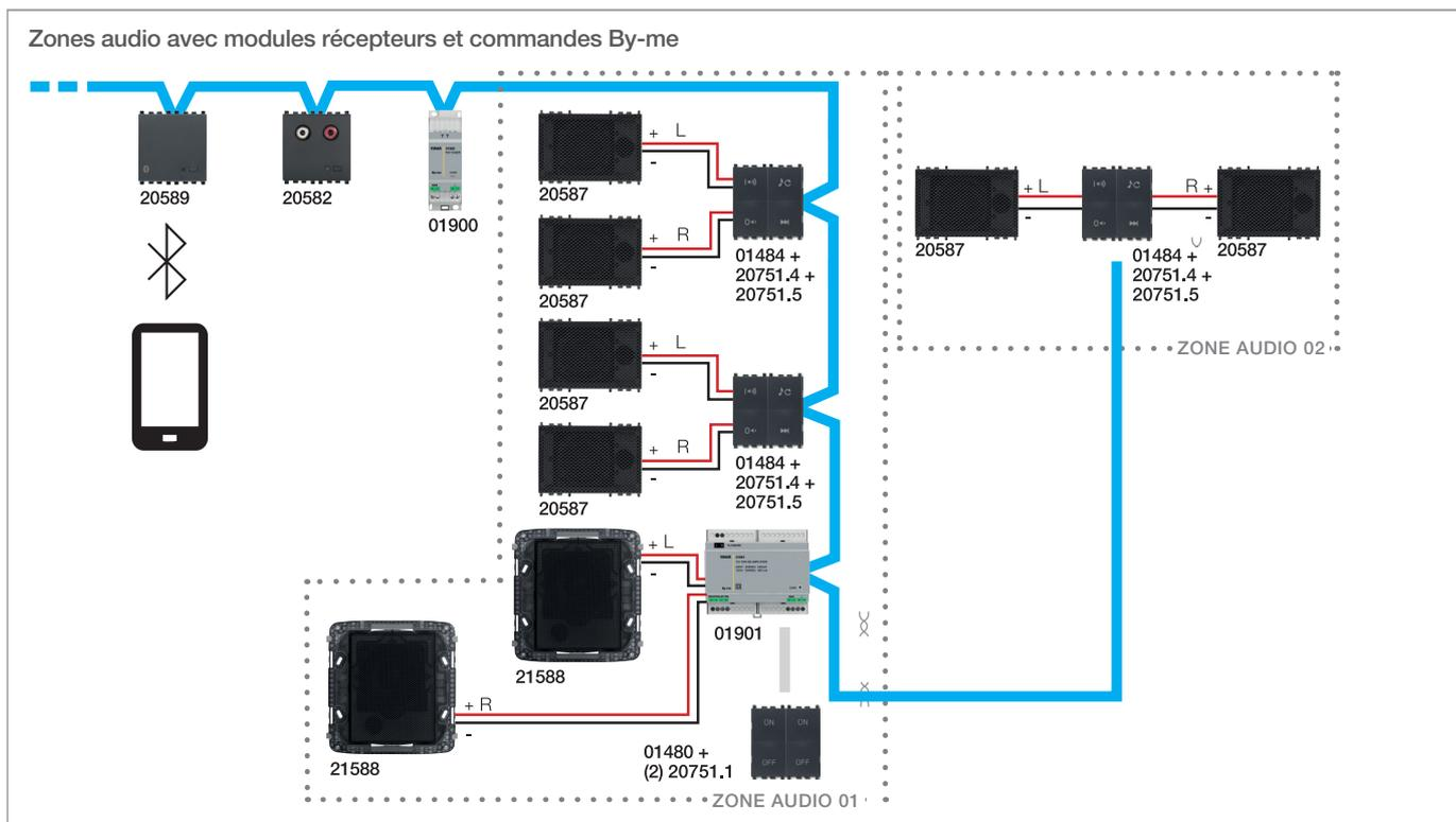
**Dispositifs configurés :** 2 entrées audio 20585 et 20582, 1 syntoniseur FM 01900 et 1 interface *Bluetooth technology* 30495-20589 (modules transmetteurs), 4 amplificateurs audio 30484-01484 (modules récepteurs) et leurs touches de commande 20751.4 et 20751.5.
