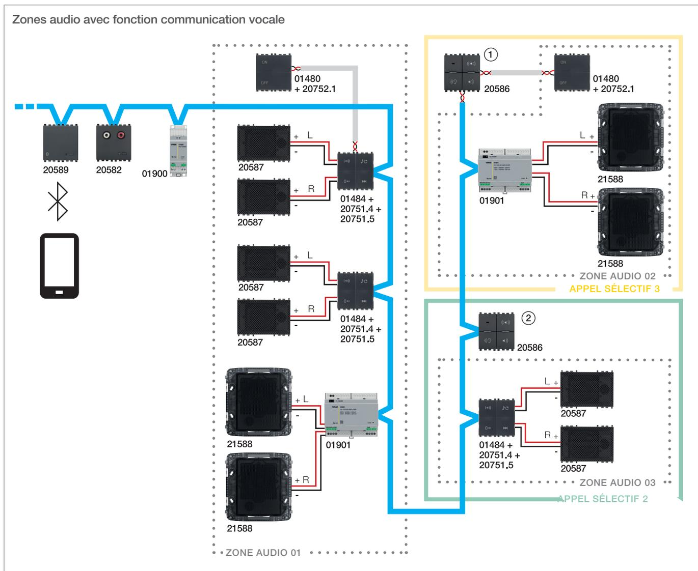
**Dispositifs configurés** : 1 entrée audio 20582, 1 syntoniseur FM 01900 et 1 interface *Bluetooth technology* 30495-20589 (modules transmetteurs), 5 amplificateurs audio 30484-01484 et 01901 (modules récepteurs) avec leurs commandes 20751.4 et 20751.5, 2 commandes By-me 30480-01480 et 2 modules micro d'appel 20586 (transmetteurs).
