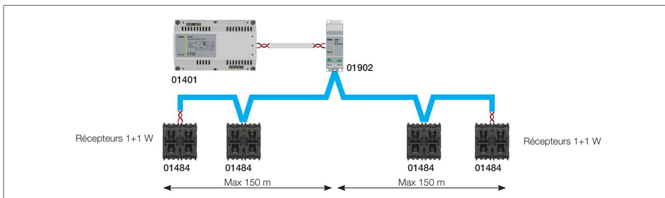
En fonction du nombre de transmetteurs et de récepteurs (et de leur type), il est possible de calculer l'absorption du système et donc le nombre d'alimentations nécessaires, au maximum 2. Si on souhaite installer beaucoup de récepteurs 1+1 W (art. 30484-01484), il est conseillé d'utiliser les alimentations auxiliaires 20580-19580-14580.
