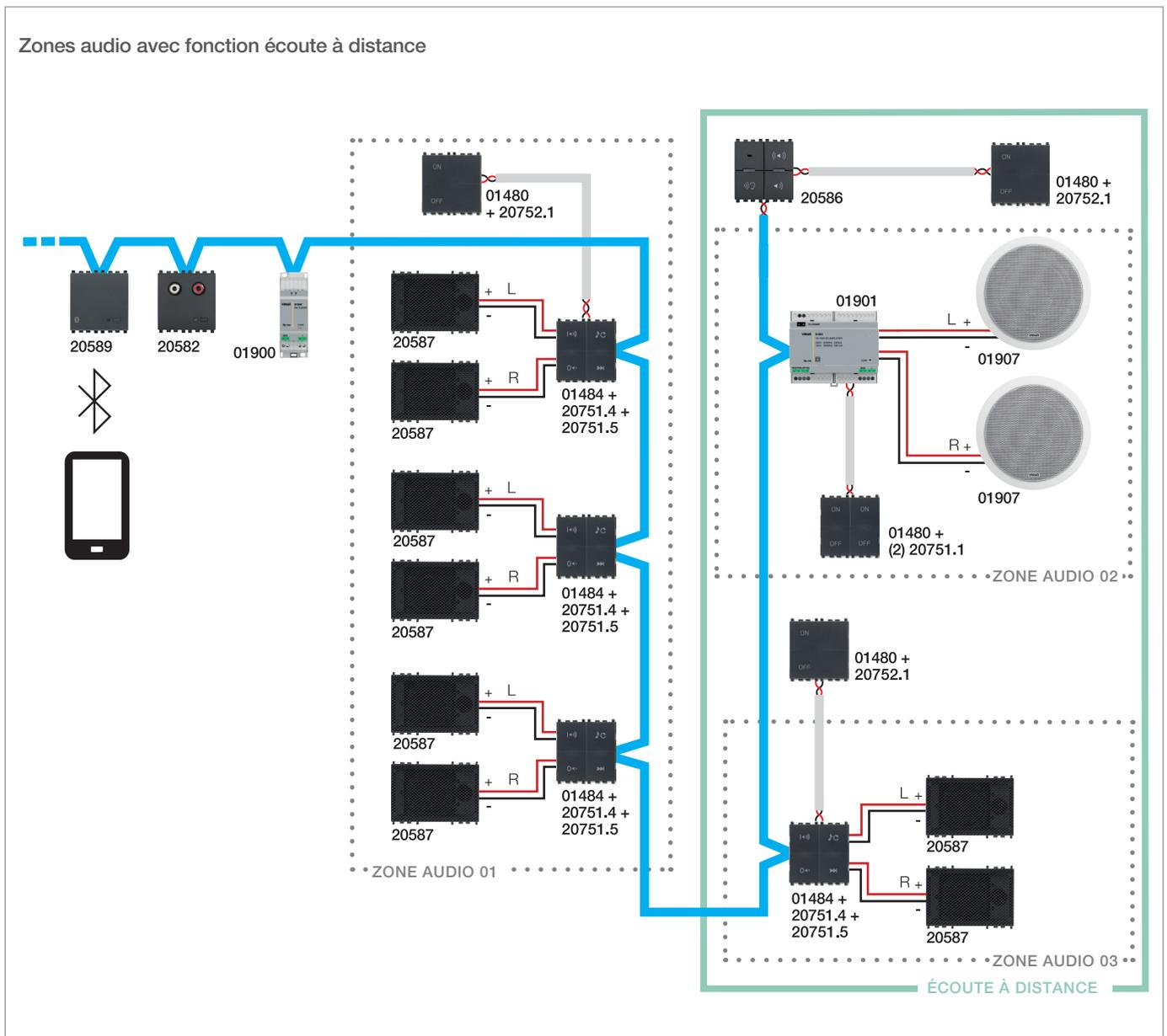
**Dispositifs configurés :** 1 entrée audio 20582, 1 syntoniseur FM 01900 et 1 interface *Bluetooth technology* 30495-20589 (modules transmetteurs), 5 amplificateurs audio 30484-01484 et 01901 (modules récepteurs) et leurs commandes 20751.4 et 20751.5, 3 commandes By-me 30480-01480 et 1 module micro d'appel 20586 (transmetteur)
