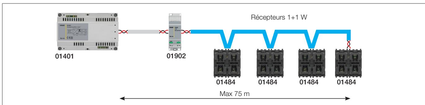
Par contre, si les dispositifs sont sur des branches opposées à l'alimentation By-me, la distance par rapport à l'alimentation doit être calculée en comptant les dispositifs présents.
