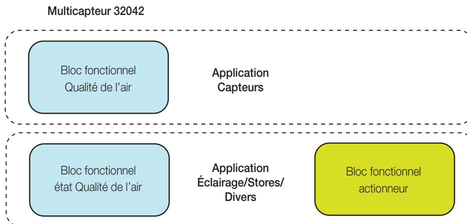
**Remarque :** En alternative à cette fonction, il est possible d'utiliser le bloc fonctionnel d'état de la qualité de l'air pour créer un actionneur de scénario pour le même événement (voir paragraphe 4.3.8 Application SCÉNARIOS de ce manuel).
