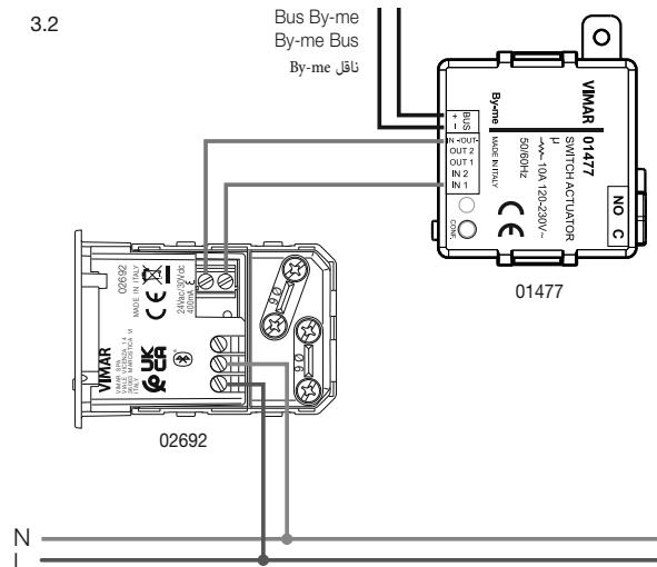
4. Collegamento a relè di potenza per comando luce • Connection to the power relay for light control • Branchement au relai de puissance pour la commande de l'éclairage
