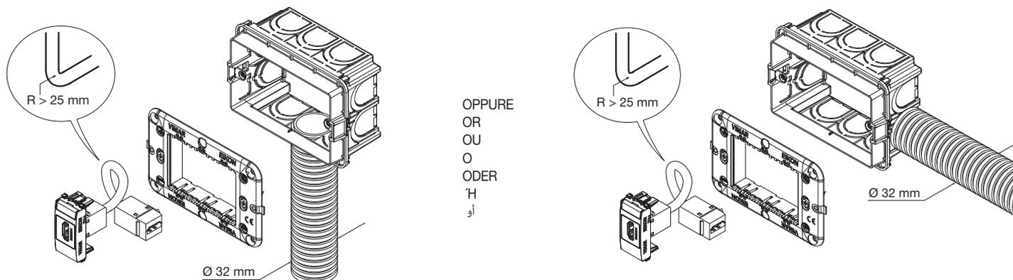
R: Raggio di curvatura del cavo • Radius of curvature of the cable • Rayon de courbure du câble • Radio de curvatura del cable • Biegeradius des Kabels • Ακτίνα κάμψης του καλωδίου • مدى منحني الكابل
