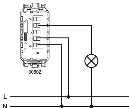
Esempio di circuito luce con pulsanti e relè in un nuovo impianto • Example of a light circuit with push buttons and relays in a new system
