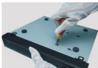
5- Capovolgere l'apparecchiatura e fissare l'HDD.
