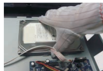
3- Collocare l'HDD sul fondo del case.
