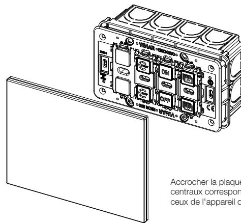
Accrocher la plaque de sorte que les contacts centraux correspondent parfaitement avec ceux de l'appareil de commande 21860.
