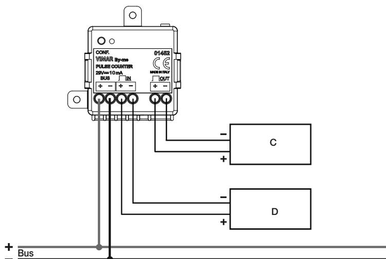
C: Altro contatore di impulsi - Other pulse counter - Autre compteur d'impulsions
