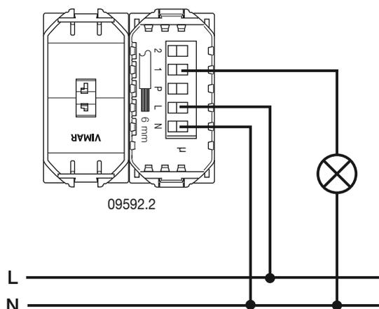
Ejemplo de circuito de luz con pulsadores y relés en una nueva instalación.
