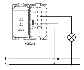
Exemple d'un circuit d'éclairage avec poussoirs et relais sur une nouvelle installation.
