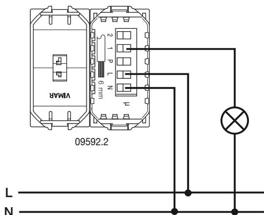
Esempio di circuito luce con pulsanti e relè in un nuovo impianto.
