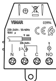
N: Eingang für die an den Nullleiter verkabelte ON/OFF-Taste (die Klemme L ist direkt an die Phase anzuschließen).
