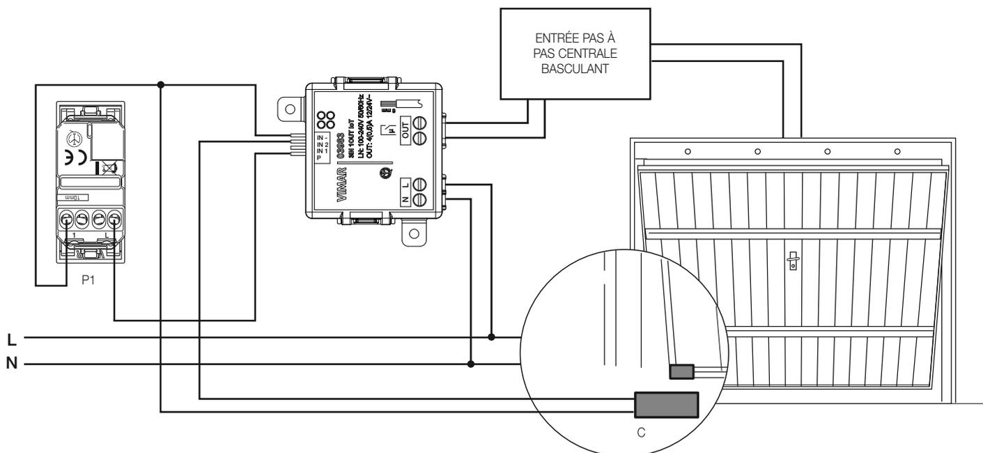
C : Contact magnétique pour protection de portails basculants, sectionnels et de rideaux roulants (art. 01824).
