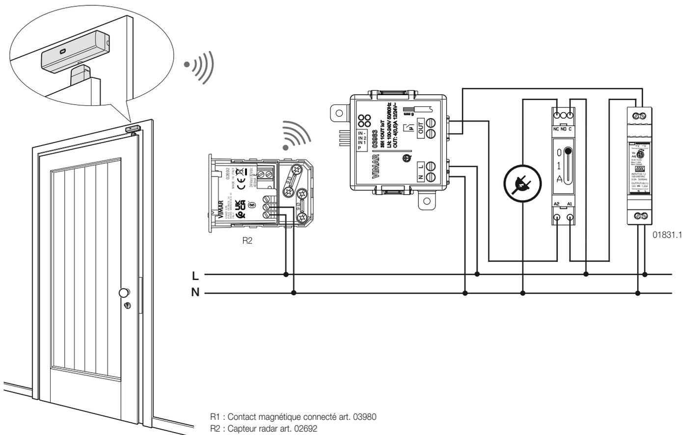
Ce type de connexion permet de configurer le module 03983 comme un capteur logique de présence qui communique via Bluetooth avec les capteurs View Wireless (contact magnétique 03980 et capteur radar 02692).
