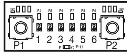
Les menus de programmation se distinguent par les combinaisons de clignotement des leds (du n° 3 au n° 6). Pour sélectionner les menus et y naviguer, utiliser les boutons P1 et P2.
