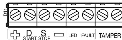
+ : Positif de l'alimentation. En cas de connexion à 2 fils, fait également office de borne d'alarme.
