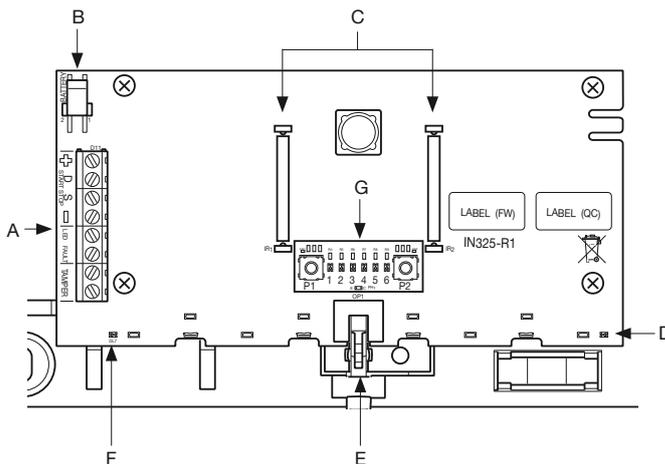
A : Bornes de connexion (pour le détail, voir fig. BORNES)
