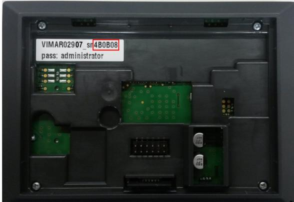
Fig. 6 : Arrière du thermostat 02907
