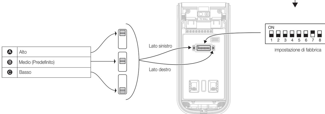
\* Uscite di allarme; ON/OFF delle singole uscite tramite DIP switch N.3
