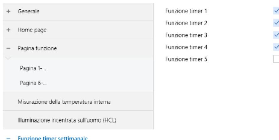
Fig. 5.6 Finestra dei parametri “Impostazioni Funzione timer settimanale”
