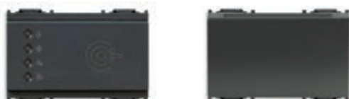
16927 Transponder čitač za instalaciju izvan sobe, standard KNX, 2 relejna izlaza NO 4 A 24 V~, 2 ulaza, 12-24 V~ 50/60 Hz i 12-24 Vdc (SELV) - 3 modula. Dostavlja se bez transponder kartica. Dubina: 36,5 mm 16923 Transponder čitač s okomitim pretincem za instalaciju unutar sobe, standard KNX, 2 relejna izlaza - NO 4 A 24 V~, 2 ulaza, 12-24 V~ 50/60 Hz i 12-24 Vdc (SELV) - 3 modula. Dubina: 36,5 mm
