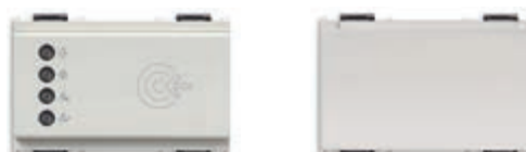
16927.B Transponder čitač za instalaciju izvan sobe, standard KNX, 2 relejna izlaza NO 4 A 24 V~, 2 ulaza, 12-24 V~ 50/60 Hz i 12-24 Vdc (SELV) - 3 modula. Dostavlja se bez transponder kartica. Dubina: 36,5 mm 16923.B Transponder čitač s okomitim pretincem za instalaciju unutar sobe, standard KNX, 2 relejna izlaza - NO 4 A 24 V~, 2 ulaza, 12-24 V~ 50/60 Hz i 12-24 Vdc (SELV) - 3 modula. Dubina: 36,5 mm
