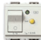
16511.16.6.B C 16, I_{\Delta n} 10 mA, prekidna moć 3000 A - 2 modula. Dubina: 38 mm
