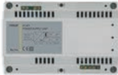
01401 Napojna jedinica, 29 Vdc, 1280 mA, 120-230 V~ 50/60 Hz, 8 modula x 17,5 mm
