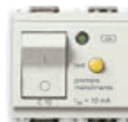
16511.10.B C 10, I_{\Delta n} 10 mA, prekidna moć 3000 A - 2 modula. Dubina: 38 mm
