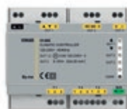
■ 01465 Klimatski regulator za toplinska postrojenja, 120-230 V~ 50/60 Hz, 3 ulaza za sonde PT100, PT1000 i NTC, 1 izlaz za miješni ventil, 1 izlaz 0-10 V ili (0)-20 mA, 1 preklopni izlaz za relej 8 A 230 V~
