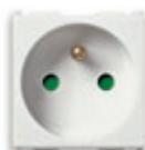
■ 14212.AB Utičnica SICURY 2P+T 16 A 250 V~, francuski standard - 2 modula
