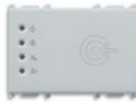
■ 14457.SL Transponder čitač za instalaci- ju izvan sobe, standard KNX, 2 relejna izlaza NO 4 A 24 V~, 2 ulaza, 12-24 V~ 50/60 Hz i 12-24 Vdc (SELV) - 3 modula. Dostavlja se bez transponder kartica
