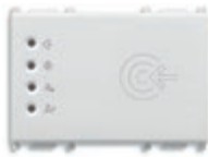
■ 14457 Transponder čitač za instalaci- ju izvan sobe, standard KNX, 2 relejna izlaza NO 4 A 24 V~, 2 ulaza, 12-24 V~ 50/60 Hz i 12-24 Vdc (SELV) - 3 modula. Dostavlja se bez transponder kartica
