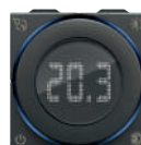
09470.CM Термостат с ротативен бутон за регулиране на температурата, 5(2) A 240 V~ релейни изходи, отопление и климатизация ON/OFF, устройство за контрол на температурата Class I ( \pm 1\% ) в режим ON/OFF, бяла LED подсветка и регулиране на яркостта, 100-240 V 50/60 Hz - 2 модула. Дълб.: 28,5 мм
