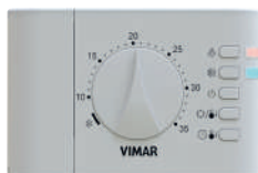
02900.1 Електронен термостат за ON/OFF контрол на температурата (отопление и климатизация), устройство за контрол на температурата Class I ( \pm 1\% ), превключващ релейен изход 5(2) A 240 V~, захранване с батерии AA LR6 1,5 V (не са вкл.), повърхностен монтаж, бял
