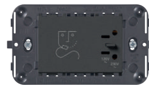
09290.CM Контакт за самобръсначка с 20 VA изолиращ трансформатор, 230 V~ 50/60 Hz, 230 V~ и 120 V~ изходи -3 модула. Дълб.: 42 мм
