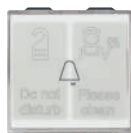
09097 Бутон 1P NO 10 A 230 V~, за хотел „Не безпокойте“ и „Моля, почистете“ с подсветка -2 модула. Дълбочина: 27,2 мм
