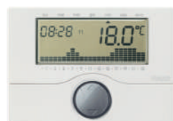
01910 Електронен таймер-термостат за ON/OFF контрол на температурата (отопление и климатизация), дневно/седмично програмиране, Class I ( \pm 1\% ), превключващ релейен изход 5(2) A 250 V~, захранване с батерии AA LR6 1,5 V (не са вкл.), повърхностен монтаж, бял
