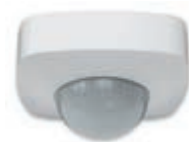
02690 Rivelatore di presenza e movimento, per accensione lampade incandescenza 2000 W, CFL 10-1000 W, LED 100 W, 220-240 V~ 50/60 Hz, installazione a soffitto
