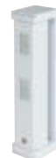
01740 Ανιχνευτής κουρτίνας By-alarm για την προστασία διόδων και κουφωμάτων, όπως θυρών, παραθύρων, σκεπαστών βεραντών, διαδρόμων και τζαμαριών. Ανίχνευση με ανιχνευτή κουρτίνας μικρής εμβέλειας με ρυθμιζόμενο φακό έως 2 m ή 5 m, ατρωσία PET, λειτουργία προστασίας από την κάλυψη, 1 εξόδος με ρελέ NO ή NC 28 V dc 0,1 A, επιτοίχια εγκατάσταση, τροφοδοσία 9,5-18 Vdc 20 mA
