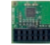
▲03813 Μονάδα σύνθεσης ομιλίας, αυτόματη αποστολή επικοινωνιών, συναγερμών, βλαβών ή δυσλειτουργιών. Γλώσσα Ιταλικά
