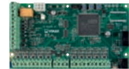
▲03800 Κεντρική μονάδα ελέγχου By-alarm Plus με δυνατότητα επέκτασης στις 25 ζώνες
