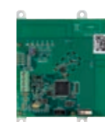
▲03832 Πλακέτα πομποδέκτη, σύνδεση στην κεντρική μονάδα μέσω Bus, 2 κεραίες για οριζόντια και κατακόρυφη πόλωση σε διαφορισμό κεραίας
