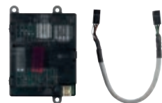
▲03812 Gateway συναγερμού παραβίασης με δίκτυο IP/LAN, για σύνδεση στο Cloud Vimar, smartphone, tablet και οθόνη αφής επίβλεψης
