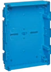
V53324 Χωνευτό κουτί 24 στοιχείων (GW 650°C) για τοιχοποιία. Διαστ. 316x423x80 mm V53724 Όπως παραπάνω, για γυψοσανίδες
