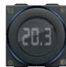
09470.CM Thermostat mit Drehregler und Relaisausgang 5(2) A 240 V~, Heizung und Kühlung in ON/OFF-Regelung, Temperaturregler der Klasse I (Beitrag 1%), weiße LED-Hintergrundbeleuchtung mit Helligkeitsregelung, Spannungsversorgung 100-240 V 50/60 Hz, - 2 Module. Tiefe: 28,5 mm
