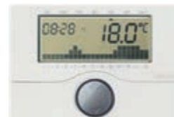
01910 Elektronischer Uhrenthermostat für die ON/ OFF-Raumtemperaturregelung (Heizung und Klimaanlage), Tages/Wochenprogrammierung, Temperaturregler der Klasse I (Beitrag 1%), Wechselrelaisausgang 5(2) A 250 V~, Stromversorgung über Akkus AA LR6 1,5 V (nicht mitgeliefert), Wandinstallation, Weiß
