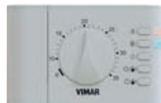
02900.1 Elektronischer Thermostat für die ON/OFF- Raumtemperaturregelung (Heizung und Klimaanlage), Temperaturregler der Klasse I (Beitrag 1%), Wechselrelaisausgang 5(2) A 240 V~, Stromversorgung über Akkus AA LR6 1,5 V (nicht mitgeliefert), AP-Einbau, weiß
