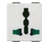
*09257 Multistandard- Steckdose SICURY 2P+E 13 A 250 V~ - 2 Module. Tiefe: 18,7 mm
