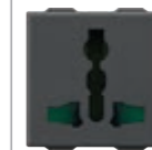
*09257.CM Multistandard- Steckdose SICURY 2P+E 13 A 250 V~ - 2 Module. Tiefe: 18,7 mm
