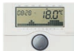
01910 Электронный хронотермостат для управления температурой в помещении в режиме ВКЛ/ВЫКЛ (отопление и кондиционирование), суточное/недельное программирование, устройство контроля температуры класса I (доля 1%), выход реле переключения 5(2) А 250 В~, питание от батареек AA LR6 1,5 В (не входят в комплект), настенный монтаж, белый
