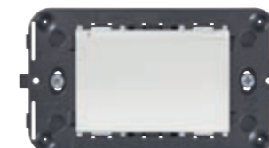
09465 Электронный выключатель для вертикального бейджа, 230 В~ 50/60 Гц, 24 В~/24 В пост. тока (SELV) - 3 модуля. Глубина: 37 мм
