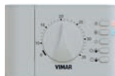
02900.1 Электронный термостат для управления температурой в помещении в режиме ВКЛ/ВЫКЛ (отопление, кондиционирование), устройство контроля температуры класса I (доля 1%), выход реле переключения 5(2) А 240 В~, питание от батареек AA LR6 1,5 В (не входят в комплект), настенный монтаж, белый
