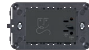
09290.CM Розетка для электробритвы с изолирующим трансформатором 20 ВА, питание 230 В ~ 50-60 Гц, выход 230 В~ и 120 В~ - 3 модуля. Глубина: 42 мм
