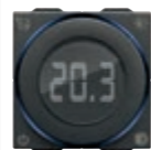
09470.CM Thermostat à molette avec sortie à relais 5(2) A 240 V~, chauffage et climatisation en modalité ON/OFF, dispositif de contrôle de la température appartenant à la classe I (contribution 1%), rétroéclairage à LED blanche avec réglage de l'intensité, 100-240 V 50/60 Hz - 2 modules. Profondeur: 28,5 mm
