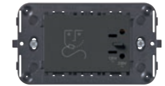
09290.CM Prise à rasoir avec transformateur d'isolation 20 VA, alimentation 230 V~ 50-60 Hz, sorties 230 V~ et 120 V~ - 3 modules. Profondeur: 42 mm
