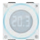
09470 Thermostat à molette avec sortie à relais 5(2) A 240 V~, chauffage et climatisation en modalité ON/OFF, dispositif de contrôle de la température appartenant à la classe I (contribution 1%), rétroéclairage à LED blanche avec réglage de l'intensité, 100-240 V 50/60 Hz - 2 modules. Profondeur: 28,5 mm
