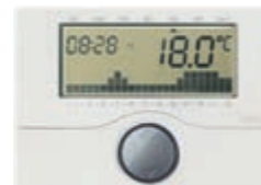
01910 Chronothermostat électronique de contrôle ON/OFF de la température ambiante (chauffage et climatisation), programmation quotidienne/hebdomadaire, dispositif de contrôle de la température classe I (contribution 1%), sortie à relais avec contact inverseur 5(2) A 250 V~, alimentation par piles stylo AA LR6 1,5 V (non livrées), installation en saillie, blanc
