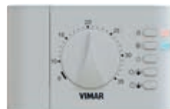
02900.1 Thermostat électronique pour le contrôle ON/OFF de la température ambiante (chauffage, climatisation), dispositif de contrôle de la température classe I (contribution 1%), sortie à relais avec contact inverseur 5(2) A 240 V~, alimentation par batteries AA LR6 1,5 V 1,5 V (non livrées), installation en saillie, blanc
