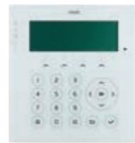
▲03817 Tipkovnica s LCD zaslonom, 12 Vdc, 23 tipke s pozadinskim osvjetljenjem, 5 LED lampica statusa, zidna instalacija. Dim. 140,3x150,3x21,6 mm
