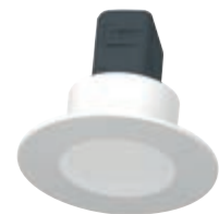
02692 Radarski senzor UWB, tehnologija IoT prema standardu Bluetooth® wireless technology 5.0 za realizaciju sustava mreže View Wireless, 1 izlaz u čvrstom stanju za komande pod krajnje niskim naponom (SELV i non SELV), 1 ulaz za vanjski gumb za aktiviranje izlaza ili za pozivanje jednog scenarija, napajanje 100-240 V 50/60 Hz, instalacija u spuštenu strop
