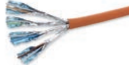
03086.E Cat. 6A, S/FTP, 4 coppie, 23 AWG, con guaina in LSZH, Classe CPR Eca, idoneo per installazione con cavi energia di I Categoria (U0 = 400 V), arancione - bobina da 500 m
