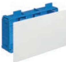
V72007 Con coperchio bianco. Dimensioni scatola: 298x164x73,5 mm Dimensioni coperchio: 323x190 mm Potenza dissipata: 25 W
