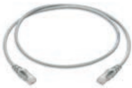
03017.05 RJ45 Cat. 5e, U/UTP, 4 coppie, 24 AWG, guaina in PVC, grigio - 0,5 m
