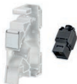
03002.13 Fornito con connettore Netsafe Cat. 6 UTP, non schermato, cablaggio universale T568A/B, 8 contatti, morsetti ad incisione d'isolante senza utilizzo di utensile
