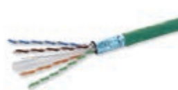
03076.E Cat. 6, F/UTP, 4 coppie, 23 AWG, con guaina in LSZH, Classe CPR Eca, idoneo per installazione con cavi energia di I Categoria (U0 = 400 V), verde - bobina da 500 m
