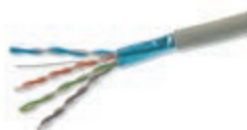
03060.E Cat. 5e, F/UTP, 4 coppie, 24 AWG, con guaina in PVC, Classe CPR Eca, idoneo per installazione con cavi energia di I Categoria (U0 = 400 V), grigio - box da 305 m
