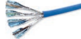
03086.B2 Cat. 6A, S/FTP, 4 coppie, 23 AWG, con guaina in LSZH, Classe CPR B2ca, idoneo per installazione con cavi energia di I Categoria (U0 = 400 V), blu - bobina da 500 m
