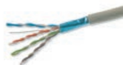
03061.E Cat. 5e, F/UTP, 4 coppie, 24 AWG, con guaina in LSZH, Classe CPR Eca, idoneo per installazione con cavi energia di I Categoria (U0 = 400 V), grigio - box da 305 m
