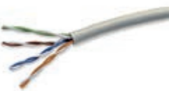
03050.E Cat. 5e, U/UTP, 4 coppie, 24 AWG, con guaina in PVC, Classe CPR Eca, idoneo per installazione con cavi energia di I Categoria (U0 = 400 V), grigio - box da 305 m
