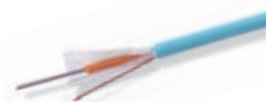
03155.E Cavo fibra ottica multimodale loose 50/125 µm OM3, 12 fibre, guaina in LSZH, Classe CPR Eca, idoneo per installazione con cavi energia di I Categoria (U0=400 V), verde acqua - bobina 500 m
