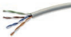
03051.E Cat. 5e, U/UTP, 4 coppie, 24 AWG, con guaina in LSZH, Classe CPR Eca, idoneo per installazione con cavi energia di I Categoria (U0 = 400 V), grigio - box da 305 m
