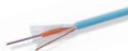
03154.E Cavo fibra ottica multimodale loose 50/125 µm OM3, 8 fibre, guaina in LSZH, Classe CPR Eca, idoneo per installazione con cavi energia di I Categoria (U0=400 V), verde acqua - bobina 500 m
