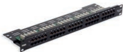
03024.3 50 connettori RJ45 per telefonia, morsetti ad incisione d'isolante compatibile 110 - 1 unità rack.
