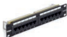
03303.3 Pannello di permutazione 10", 12 connettori RJ45 Cat. 6 UTP, cablaggio universale T568A/B, 8 contatti, morsetti ad incisione d'isolante tipo 110 - 1 unità rack
