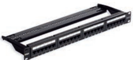
03024.6 24 connettori RJ45 Cat. 6, UTP, cablaggio universale T568A/B, 8 contatti, morsetti ad incisione d'isolante compatibile 110 - 1 unità rack
