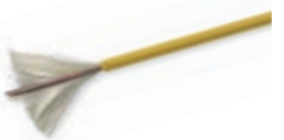
03147.E Cavo fibra ottica monomodale loose 9/125 µm OS2 (G.657.A2), 4 fibre, guaina in LSZH, Classe CPR Eca, idoneo per installazione con cavi energia di I Categoria (U0=400 V), giallo - bobina 500 m
