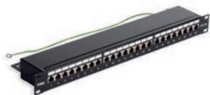
03024.5 24 connettori RJ45 Cat. 5e, FTP, cablaggio universale T568A/B, 8 contatti, morsetti ad incisione d'isolante compatibile 110 - 1 unità rack
