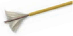
03149.E Cavo fibra ottica monomodale loose 9/125 µm OS2 (G.657.A2), 12 fibre, guaina in LSZH, Classe CPR Eca, idoneo per installazione con cavi energia di I Categoria (U0=400 V), giallo - bobina 500 m
