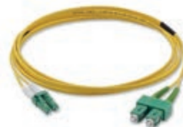
03113.SC.LC Cordone di permutazione da SC/APC a LC/APC, monomodale 9/125 µm OS2 duplex, guaina in LSZH - 2 m
