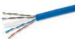
03071.B2 Cat. 6, U/UTP, 4 coppie, 23 AWG, con guaina in LSZH, Classe CPR B2ca, idoneo per installazione con cavi energia di I Categoria (U0 = 400 V), blu - bobina da 500 m
