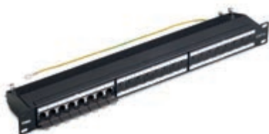
03024.7 24 connettori RJ45 Cat. 6, FTP, cablaggio universale T568A/B, 8 contatti, morsetti ad incisione d'isolante compatibile 110 - 1 unità rack
