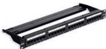
03024.4 24 connettori RJ45 Cat. 5e, UTP, cablaggio universale T568A/B, 8 contatti, morsetti ad incisione d'isolante compatibile 110 - 1 unità rack
