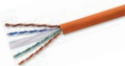
03081.E Cat. 6A, U/UTP, 4 coppie, 23 AWG, con guaina in LSZH, Classe CPR Eca, idoneo per installazione con cavi energia di I Categoria (U0 = 400 V), arancione - bobina da 500 m
