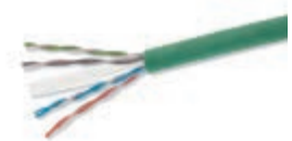
03071.E Cat. 6, U/UTP, 4 coppie, 23 AWG, con guaina in LSZH, Classe CPR Eca, idoneo per installazione con cavi energia di I Categoria (U0 = 400 V), verde - box da 305 m
