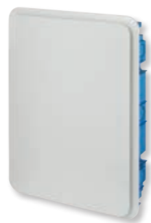
Centralino da incasso con adattatore da abbinare ai 24 moduli V53324 o V53724, per 25 e 65 zone. Fornito di slot per installazione dispositivi. Dimensioni: 344,9x444,9 mm
